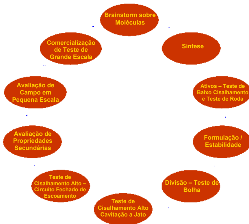
Figura 2 – Processo de Desenvolvimento de Inibidor de Corrosão
